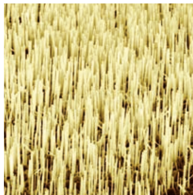
Flexibilität von Titanfolie mit aufgewachsenen GaN-Nanowire a) Fotografie, Rasterelektronenmikroskopaufnahme der GaN-Nanowire auf Titanfolie mit b) geringer und c) hoher Auflösung.
