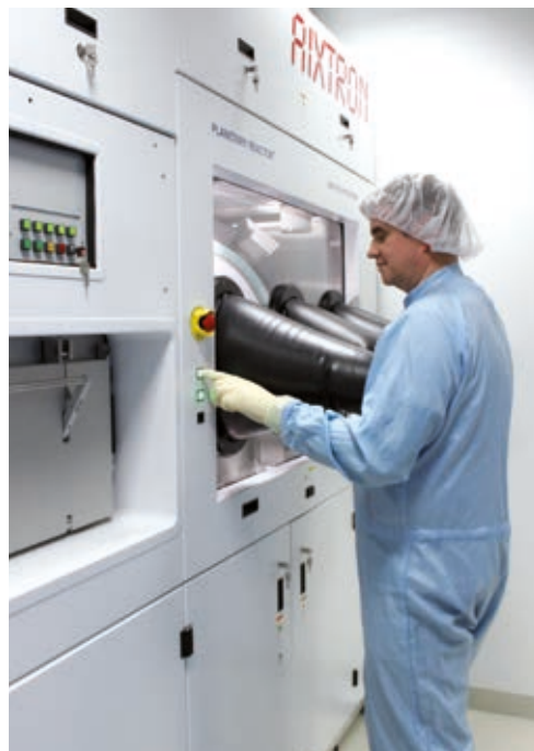
MOVPE: Epitaxieanlage zum Wachstum hauchdünner Funktionsschichten
