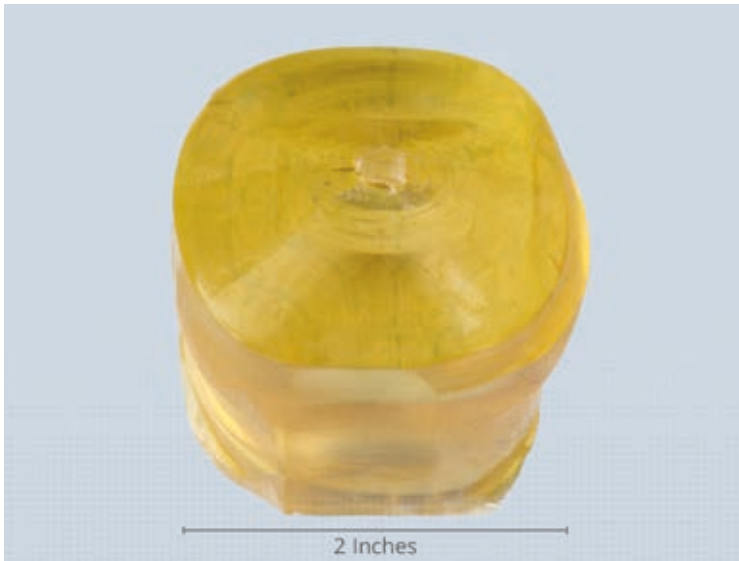
\beta -Galliumoxid-Einkristall als Substratmaterial für die Epitaxie.
