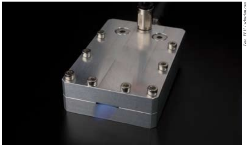
Dieses Mikrowellenplasma aus dem FBH ist kleiner als eine Zigarettenschachtel und funktioniert an der normalen Umgebungsluft.
