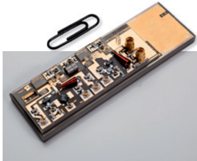
Lasermodule mit Ansteuerelektronik für hochpräzise Messungen an Bord einer Höhenforschungsrakete
