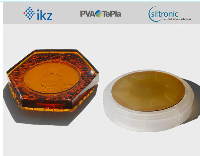
Aluminiumnitridkristall und -wafer
