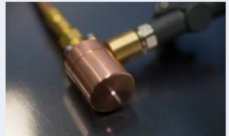
Mikrowellen-Plasmaquelle bei Atmosphärendruck.
