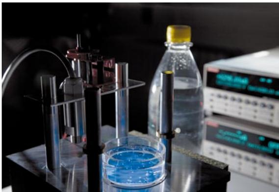
*Prototyp zur Wasserdesinfektion mit UV-Licht.*
